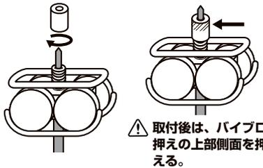
**4** スイッチをONにするとバイブロヒッター本体が振動し、JPアンカーに打撃が伝わる。
