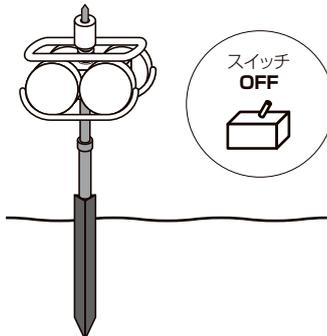
**6** バイブロヒッター類を全て外して、JPアンカー打込み完了。
