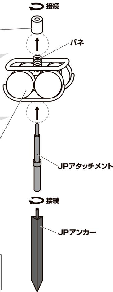
**1** JPアンカー(ジュボールアンカー杭) 上部のネジにJPアタッチメントを取付ける。
