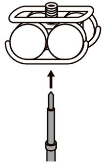
**3** JPアタッチメントにバイブロ押えを取付ける。この時、ねじ込む目安として、バイブロ押えはバイブロヒッター本体のバネ上部にかかるく触れる程度とする。
